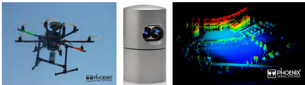
Figur 5. T.v. Ett system som uppges vara världens minsta UAV-lidar utvecklat av Phoenix Aerial Systems. I mitten den 2 kg tunga sensorn och t.h. ett exempel på data (träd plus en del av en idrottsanläggning).
