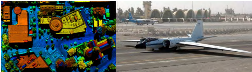
Figur 4. T.v. ett exempel på dataprodukt från HALOE (High Altitude Lidar Operational Experiment) upptaget från 14 900 m höjd. T.h. Ett flygplan för datainsamling från hög höjd. Från US Army GeospatialCentre, program Buckeye.
