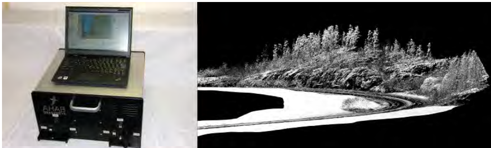
Figur 7. Ett typisk kompakt skannande lidarsystem. Dragon Eye utvecklas av AHAB i Sverige.
