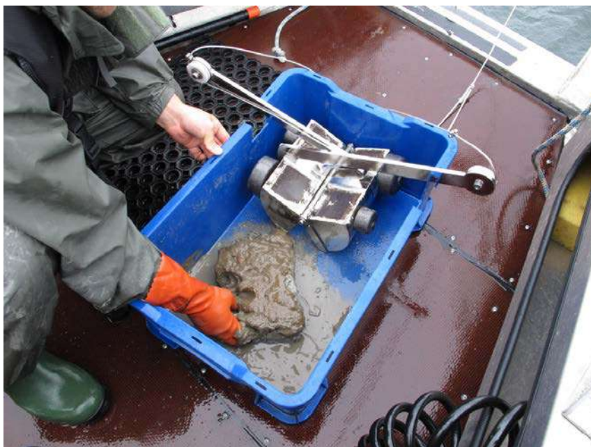
Figur 14. Ett mjukbottenprov har tagits upp med en liten Van Veen-huggare. Sällning, artbestämning och räkning utförs direkt i fält. Foto: Karl Florén.
